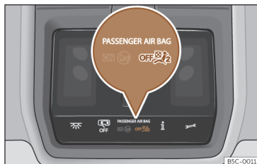
Kuva 28 Kattokonsolissa: poiskytketyn etumatkustajan turvatyynyn merkkivalo.
