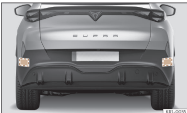
Kuva 112 Auton takaosa: tutkatunnistimien alueet.
