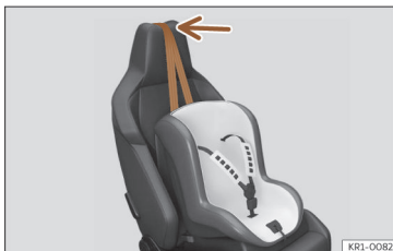
Kuva 43 Etumatkustajan istuin: säätö ja asennus käytettäessä Top Tether -vyötä.
