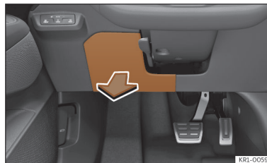
Kuva 187 Kojelaudassa kuljettajan puolella: sulakekotelon kansi.
