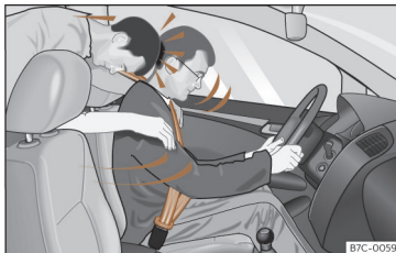
Kuva 19 Turvavyötä käyttämätön takana istuva matkustaja lennähtää eteenpäin turvavyötä käyttävän kuljettajan päälle.
