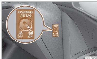
Kuva 27 Avainkytkin, josta etumatkustajan turvatyyny kytketään päälle/pois.
