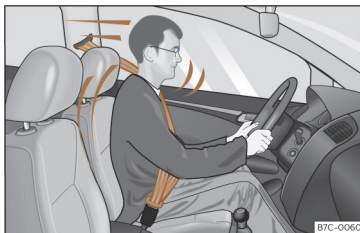
Kuva 16 Turvavyötä oikein käyttävä kuljettaja ei sinkoudu eteenpäin äkkijarrutuksessa tai -pysähdyksessä.
