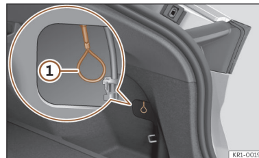
Kuva 62 Kannen takana: latauspistokkeen hätävapautus.
